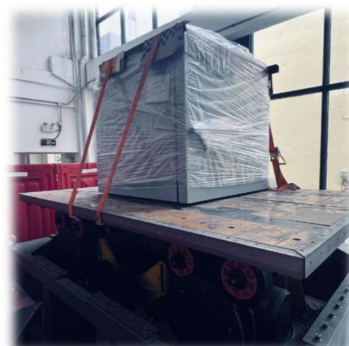
7、小型设备出货前进行振动测试
