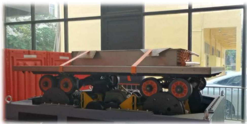
6、零部件如冷冻蒸发器等安装前进行振动测试
