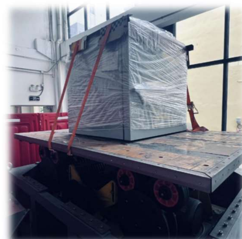
7、中小型设备出货前进行振动测试
